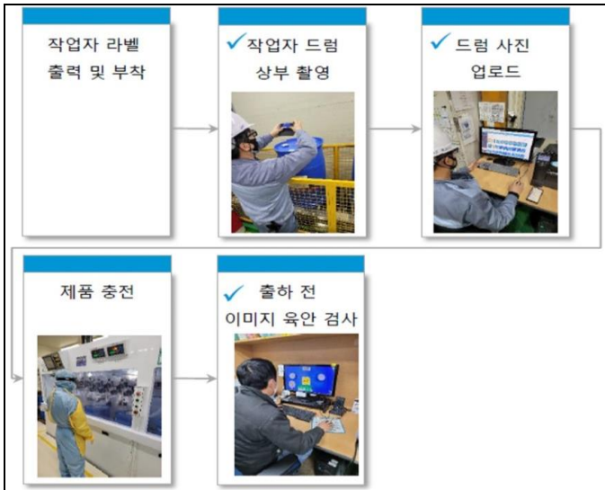
[그림 1 S사 드럼 용기 라벨 육안 검사 절차]
