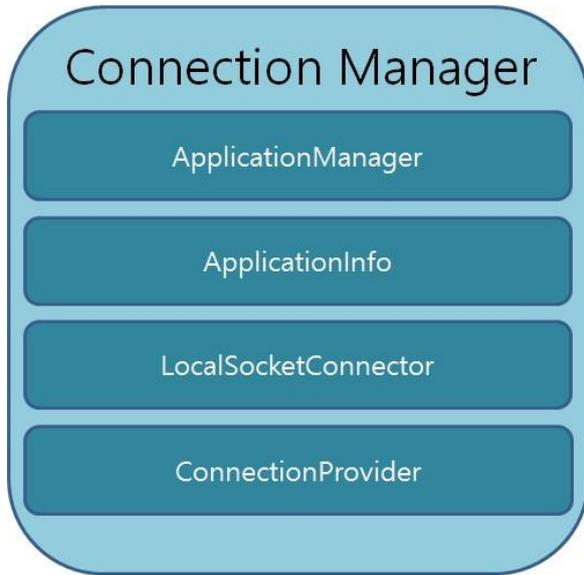
[그림11] Connection Management Module 구조도
